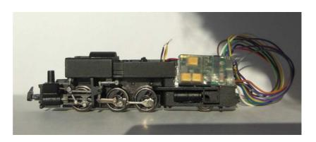
Das Ausfüllen "unnötiger Lücken" im Gewichtsblock sowie an Stelle der ursprünglichen Platine mit Trimmbleistreifen erfolgt nach gewünschter Masse, ist aber ebenso sinnvoll wie die Ausstattung der Laufachse mit Stromabnehmern (, wie in den bisherigen Umbauvorschlägen anschaulich dargestellt).
