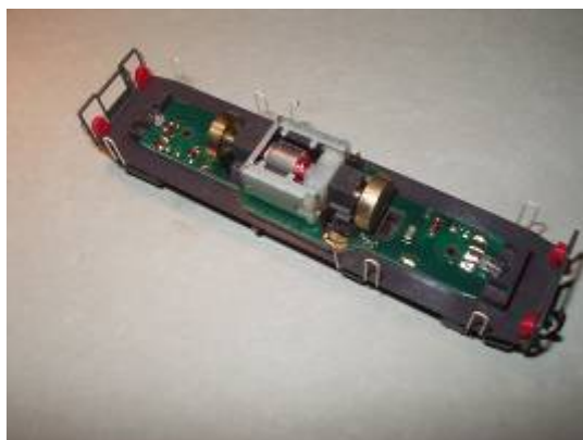
Lokrahmen, Kabel abgelötet, Platine mit Elektronik
