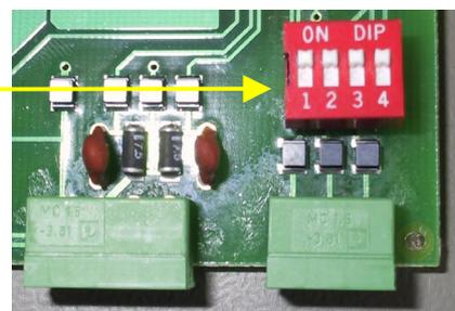
Mit den Dip-Schaltern 1 – 3 kann der Verstärkerteil nun mit dem Zentralenteil verbunden werden (Schalter auf "ON") oder vom Zentralenteil getrennt werden (Schalter auf "OFF"), Schalter 4 ist ohne Funktion.
