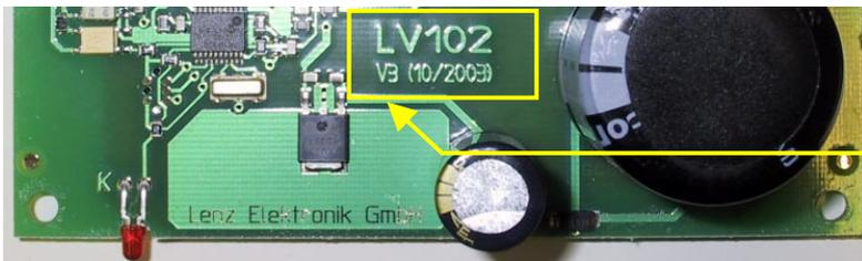
Ob Sie die neueste Hardware haben erkennen Sie an der Kennzeichnung der Leiterplatte des Verstärkerteils.
