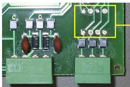
Setzen Sie von der Oberseite einen 4-poligen Dip-Schalter in die dafür vorgesehenen Bohrungen und löten Sie ihn ein.
