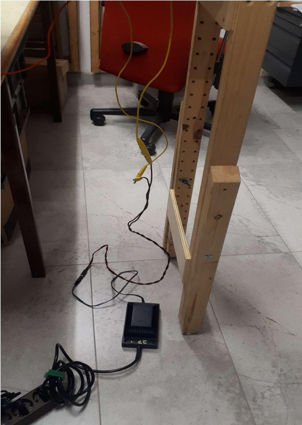
Altbrauchbare Computer-Netzteile leisten als Stromquelle für den Beleuchtungsstromkreis gute Dienste (Maximale Ampere-Zahl beachten!). Auch für die Zentralen-Stromversorgung meist gut geeignet. Eine Box mit Adapterkabeln, 4mm-Büschelstecker-Verlängerungen (M-M und M-W) und Reservekabeln für den Zentralenanschluss sollte immer mitreisen!
