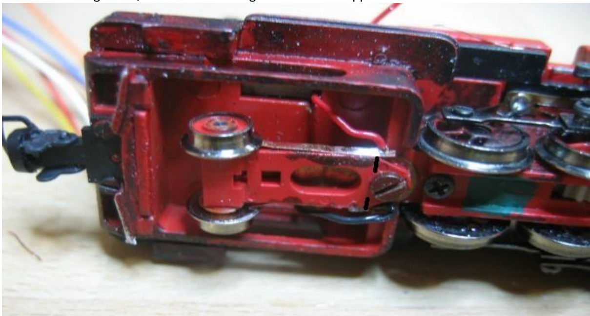
Schleppachse mit Stromabnahme; schwarze Striche markieren die Verankerungsslitze für die Kontaktbleche (90° umbiegen und einkleben)
